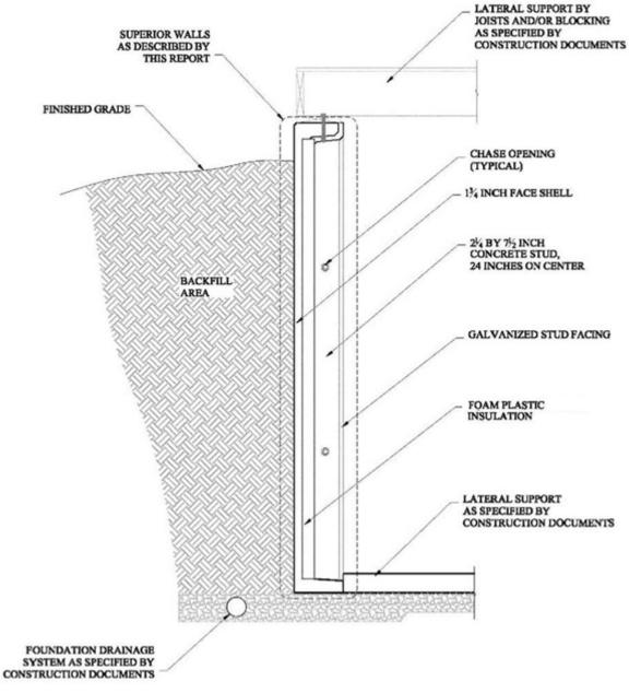
FIGURE 1—TYPICAL SUPERIOR WALL VERTICAL SECTION DETAIL
