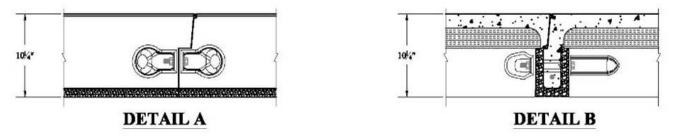
FIGURE 4—TYPICAL WALL CONNECTION DETAIL
